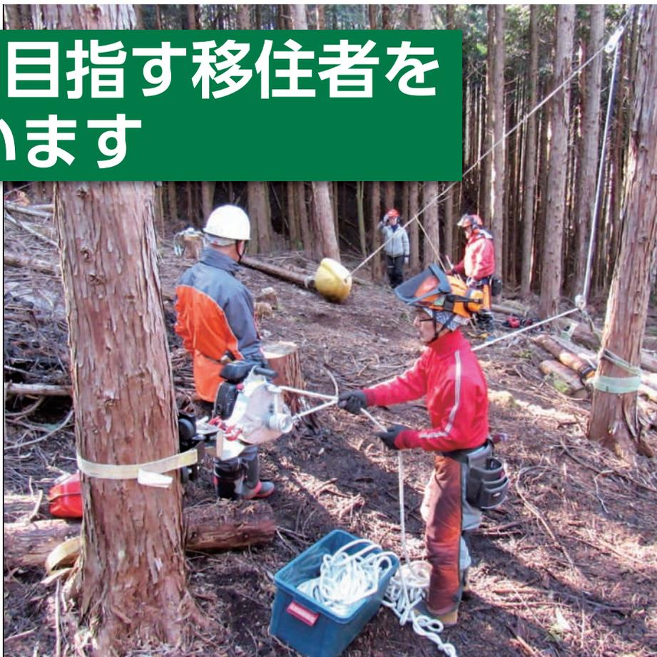
簡易集材機による木材の搬出
